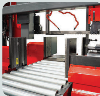
Гидравлические передние и задние тиски
