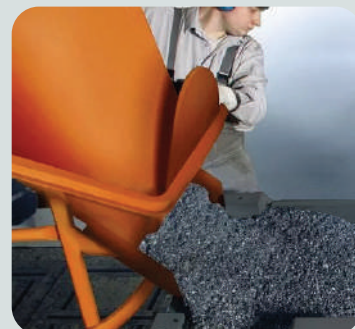
Минеральное литье основания станка и колонн
