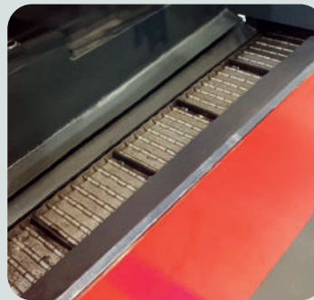
Ленточный конвейер для удаления стружки
