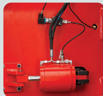
Гидравлическое натяжение полотна
