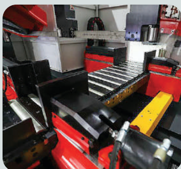
Сервопривод подающих тисков
