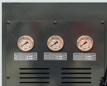
Регулируемое давление тисков
