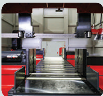
Сервопривод перемещения передних и задних тисков
