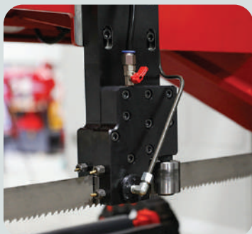
Гидравлические направляющие полотна
