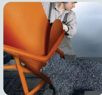
Минеральное литье основания станка и колонн
