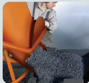
Минеральное литье основания станка
