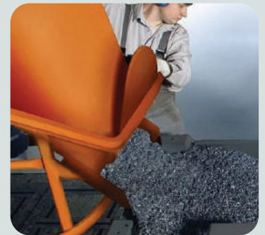
Минеральное литье основания станка и колонн
