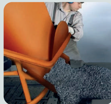
Минеральное литье основания станка и колонн
