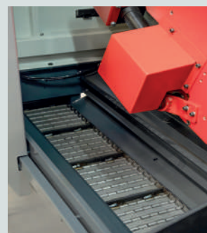
Ленточный конвейер для удаления стружки
