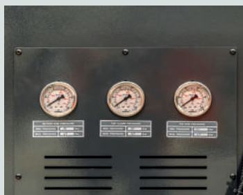
Регулируемое давление тисков
