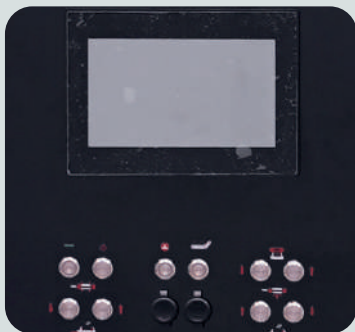
Панель управления PLC
