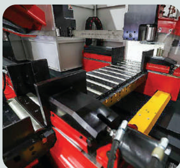
Сервопривод подающих тисков
