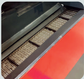
Ленточный конвейер для удаления стружки
