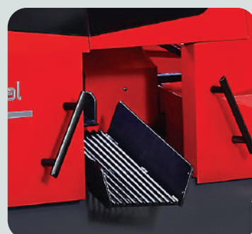
Автоматическое разделение деталью обрезки
